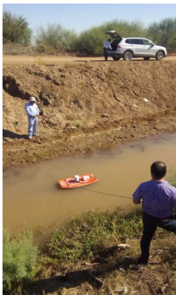
Figura 4.18. Equipo de medición de caudal y nivel de escurrimiento
